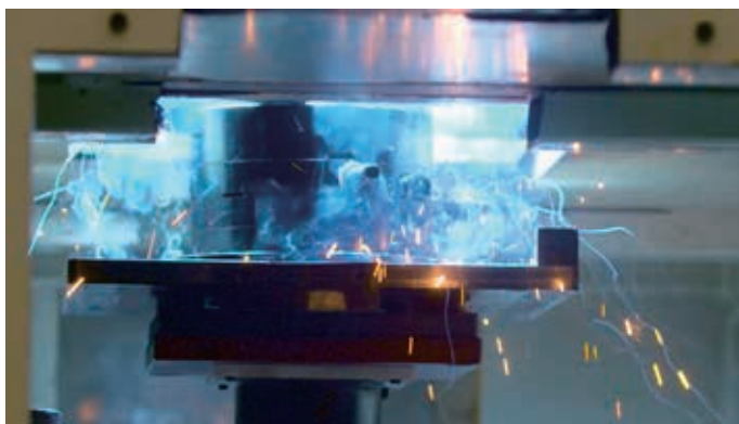
海立电器装备激光焊装配线，降低加热温度50%，年节约用电120万千瓦时
