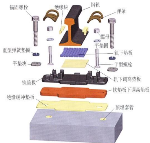
WJ-7型扣件组装零件图
