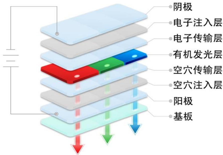
公司主要为下游面板厂商提供上图所示 OLED 各结构层的有机发光材料，按照具体用途划分，包括发光功能材料、空穴功能材料、电子功能材料及其他功能材料，公司产品以发光功能材料为主。发光功能材料按照颜色可进一步划分为红、绿、蓝发光材料，再进一步可分为红、绿、蓝发光主体材料与掺杂材料，与主体材料相比，掺杂材料的技术壁垒更高一些。公司目前生产的发光功能材料涵盖红、绿、蓝材料，以发光主体材料为主。
