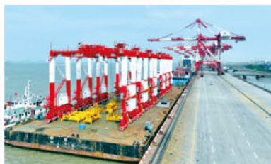
油电混合“新能源车”轮胎吊
