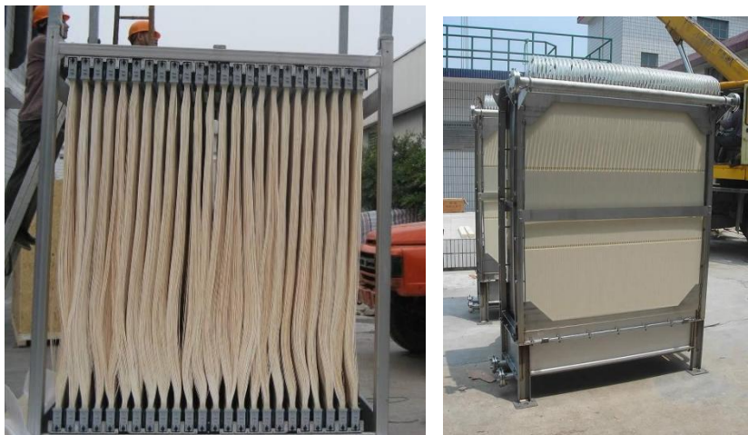
图 1-11 中空膜组件（左）与平板膜组件（右）实物图
