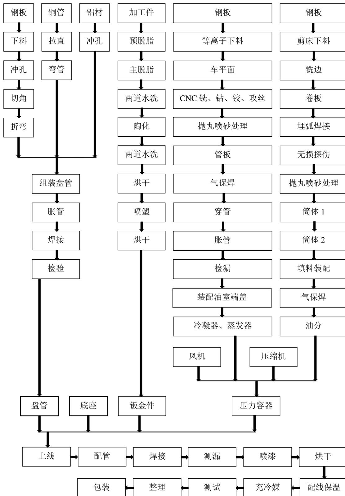
注：空调主机中除风冷主机外，其他产品的生产过程不需要盘管加工工序。
