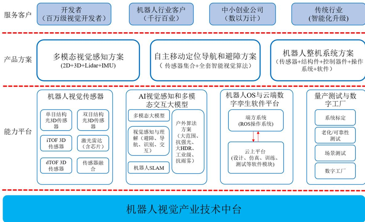
(1) **机器人视觉传感器。**旨在为机器人赋予精密的“机器人之眼”，让机器人在各类环境下都能够“看到世界”。将针对各行各业的机器人视觉需求，研发高集成度、低成本、高性能的机器人视觉传感器产品系列，包括单目结构光、iToF、dToF、双目视觉、激光雷达等；同时，为降低下游用户的使用门槛，在机器人视觉的基础上，同步搭配IMU、GPS、RTK等传感器，研发多模态感知融合技术，以满足机器人室内外各类场景感知的要求，最终将形成多模态视觉感知产品方案。
