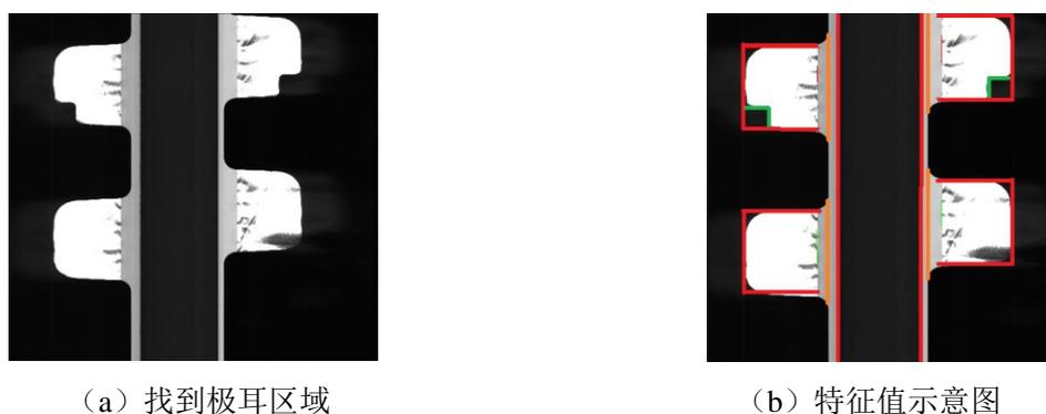
图 2 带mark孔极耳检测图
