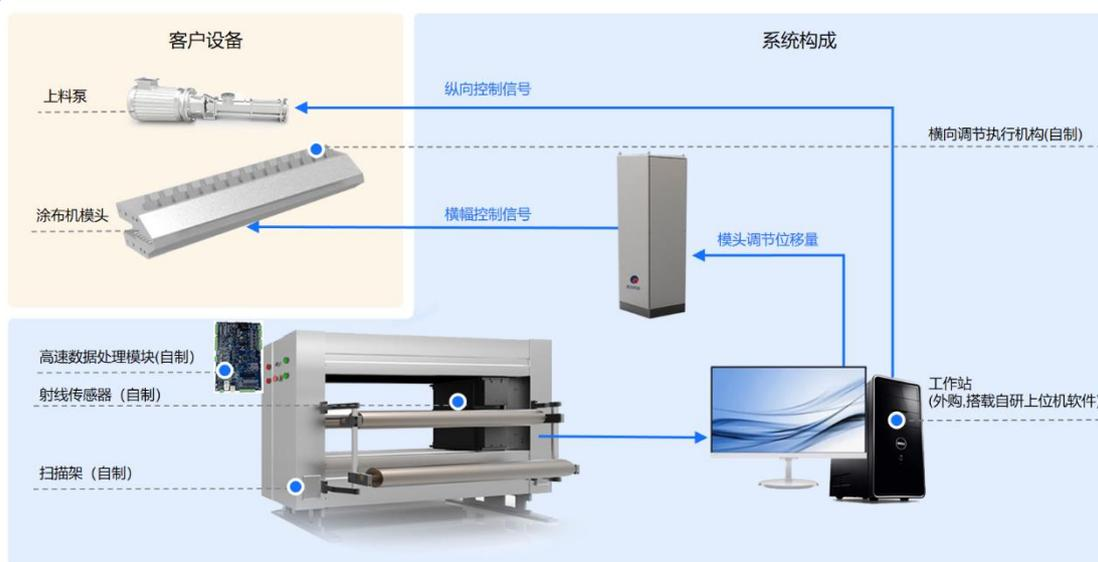
在线自动化测控系统由在线检测系统和自动化过程控制系统构成。传感器、高速数据处理模块、扫描架组成的在线检测系统对片材质量做实时在线精准扫描检测，检测数据经过滤波、对位和压缩等预处理后传输至上位机。自动化过程测控系统根据检测数据偏差，通过横纵向闭环算法计算输出控制信号，通过执行机构调节对应的供料量完成闭环反馈控制，从而保证片材品质的稳定一致。上述核心部件是构成在线自动化测控系统重要的组成部分，其自制情况及发挥的具体作用如下：
