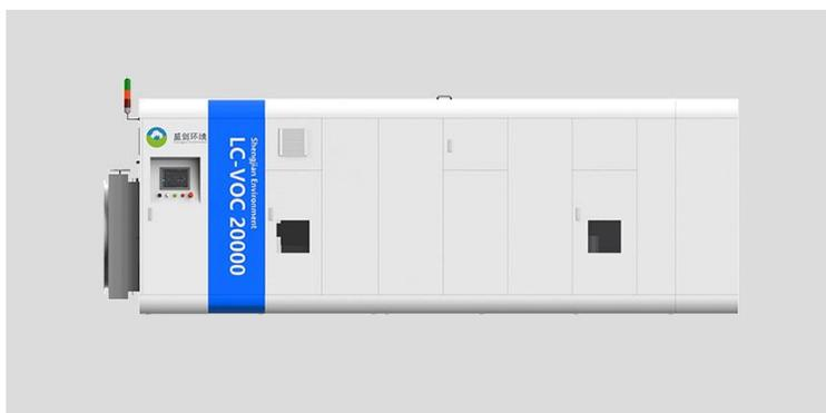
LOC-VOC 是一种泛半导体洁净室 EHS 处理装置，用于处理洁净室内弥散的 VOC 气体，保障生产员工的职业健康和安全。泛半导体行业生产车间某些区域循环风中含有一定量的挥发性 VOCs 气体，影响职业健康和产品良率。含有 VOCs 的气体通过沸石，VOCs 被吸附，洁净气体排至车间，小风量的高温气体从沸石上脱附出高浓度的 VOCs，排至 VOCs 中央处理装置，集中处理达标排放，有助于提高客户制程的产品良率。
