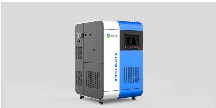
L/S 是 Local Scrubber 的简称，是泛半导体工艺设备 PFCS 污染物处理装置，用于对制程过程中产生的含氟、氯、硅等元素为代表的成分复杂的有毒有害废气进行源头处理，该设备一端与泛半导体工厂工艺设备相连，通过真空泵抽取工艺设备内产生的废气并进行分解；另一端与中央治理系统相连，将分解后的尾排气体排至中央处理装置并进行后续处理。L/S 属于泛半导体工艺制程设备的一部分，其对运行稳定性及气体处理效率要求高。
