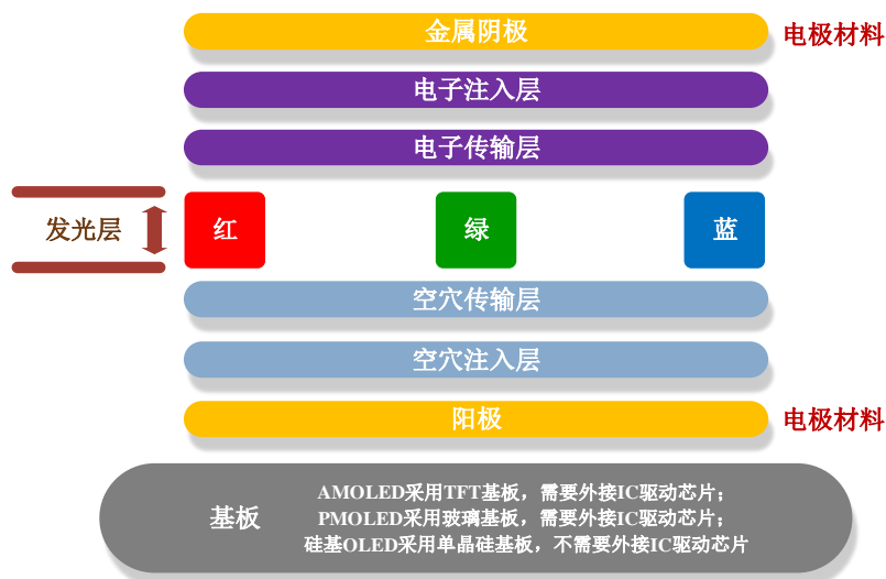
OLED 结构图
