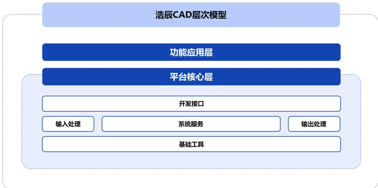
从软件系统层次来看，浩辰 CAD 的平台核心层是整个软件的底层部分，主要实现浩辰 CAD 的软件框架、核心逻辑及相关服务，包括基础工具、系统服务、输入处理、输出处理、开发接口五个部分，共有 26 个服务组件。
