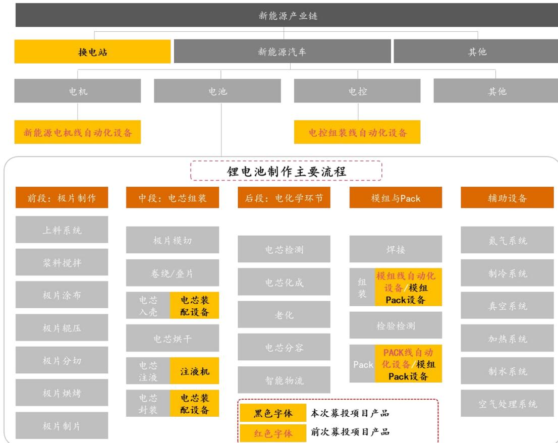
注：锂电池制作主要流程图资料来源于高工产研锂电研究所。
