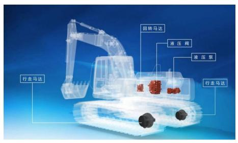
液压泵向整个液压系统提供动力;行走马达直接与液压机械的履带驱动轮或车轮相连接,驱动其直行或转向行走;回转马达一般位于液压机械的上下部件结合处,驱动上部部件旋转转向;液压阀则按操作者的指令将液压泵排出的压力油输送到各执行元件,使液压机械完成各种动作。
