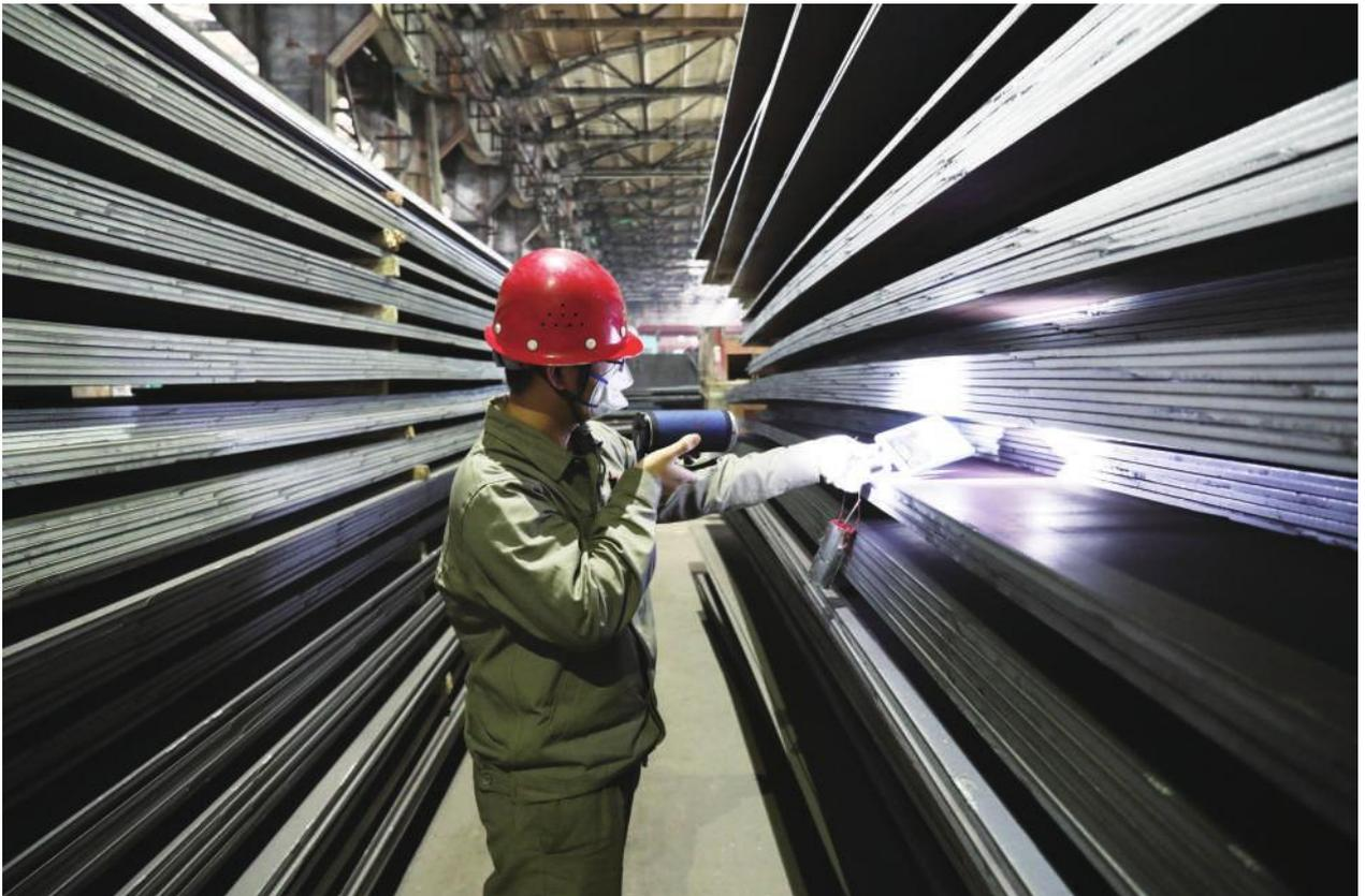
随着市场对中厚板需求不断增大，对质量的要求也在不断提高。为确保钢板出厂后不出现问题，中板厂检验车间进一步加强库房巡查管理，组织员工对入库钢板进行二次查验，减少不合格品出厂，达到降低出厂产品漏检的目标。
