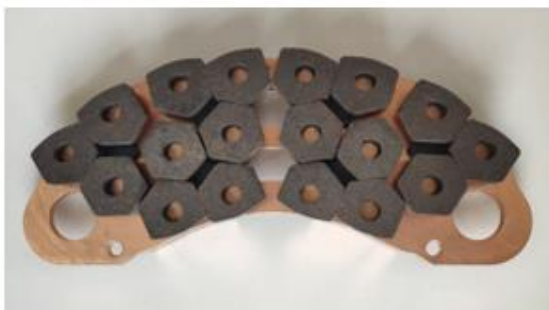
200-250 km/h 非燕尾型粉末冶金闸片 适用于 CRH1A 车型
