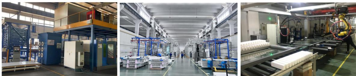
大族光纤切割机自动化改进 涂装流水线改造效能提升 机器人打胶设备取代手工
