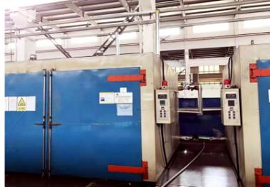
烘箱由原来电加热的改为蒸汽加热，减少了综合能耗。
