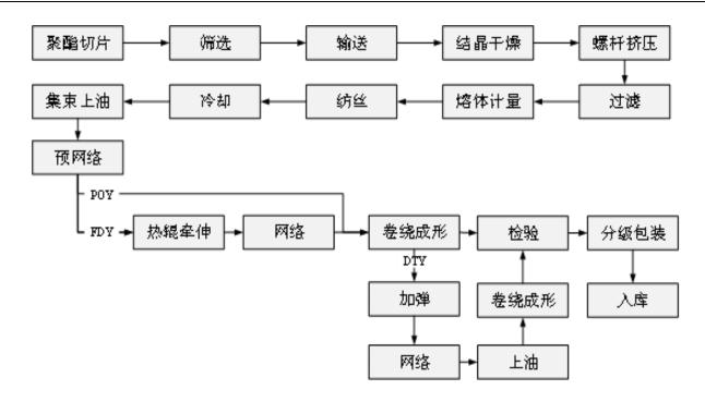
(2) 工业用单组分聚酯纤维长丝生产工艺流程
