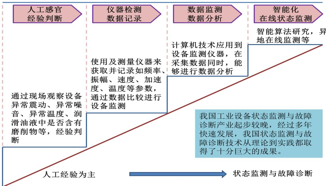
第一阶段：依靠现场获取设备运行时的感观状态，如异常振动、异常噪音、异常温度、润滑油液中是否含有磨削物等，并凭经验或多位专家进行分析研究确定可能存在何种故障或故障隐患。
