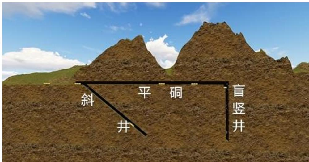
图 6：萤石采矿开拓系统示意图
