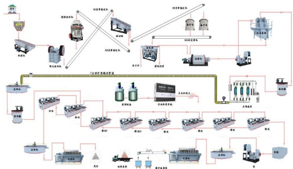
图 7：萤石选矿工艺原则流程图
