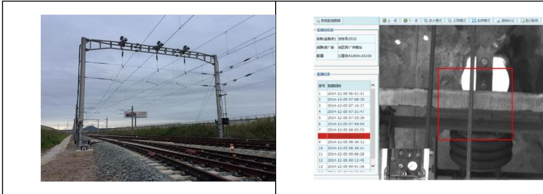
上图：受电弓滑板监测装置应用场景示例及列车受电弓缺陷识别
