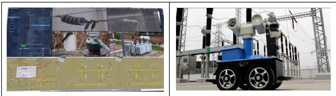
上图左：交大光芒辅助监控系统工作界面；上图右：交大光芒辅助监控系统自动巡检设备
