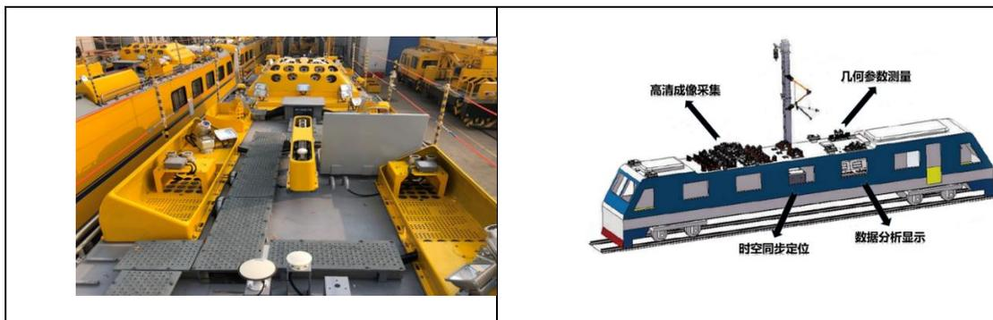
上图：GM6-4C 接触网悬挂状态检测监测装置以及与专用车辆配合工作流程示意
