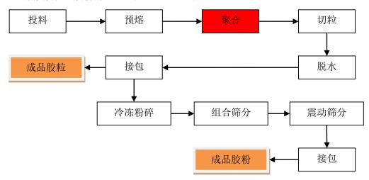
3、PES 热熔胶胶粒、胶粉的工艺流程
