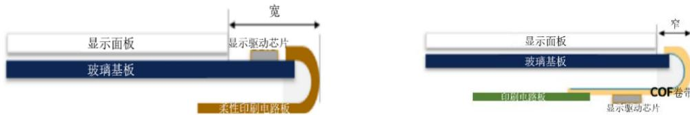
COG 由于其直接将显示驱动芯片绑定在玻璃基板的表面，玻璃基板无法进行弯折，加上排线和布局，其下边框长度略长，屏幕占全部显示面积的比例相对小一些，目前随着芯片设计与封测技术的进步，芯片体积日益缩小、集成度逐渐提高，有效提高了屏幕占全部显示区域的比例；在厚度方面，COG 因少掉基材、铜箔等，使其完成芯片封装的面板厚度相对较薄，符合市场轻、薄之需求。目前，COG 技术在行业应用中成熟稳定，主要用于中小尺寸面板产品，如手机、数码相机、平板电脑等。
