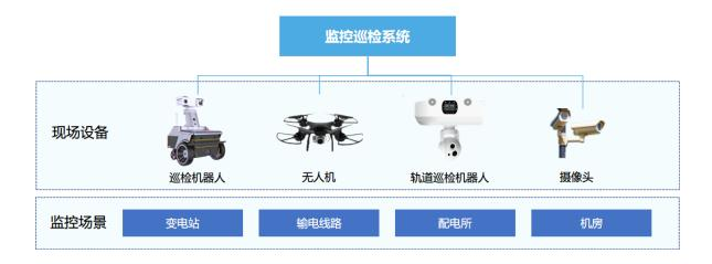
福建亿榕利用监控巡检系统,实时对基础设施、人员和物品进行巡检工作,满足了企业"集中监控,意外报警,信息完备"的管理需求,解决了以往人工巡检存在漏检、错检、误判的难题,提高了巡检效率和运维管理水平,使巡检工作走向自动化、综合化、智能化、数字化,从而保证电厂的安全稳定生产和运行。
