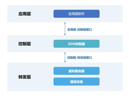
SDN 网络架构分为应用层、控制层、转发层,三个层面的软硬件相互协调配合, 共同实现网络连接、数据传输相关的各种网络业务。
