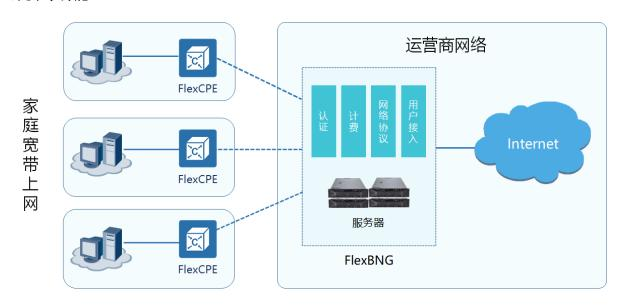
公司宽带接入网关承载在通用硬件上,摆脱了专用硬件的束缚和限制。
