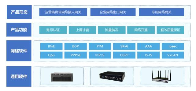
公司虚拟路由器的管理、控制、数据层面互相分离,支持业务功能的独立部署和动态扩展;软硬件解耦,不绑定特定专用设备,实现业务资源灵活调度及快速部署,缩短上线周期。按需分配虚拟主机资源来动态调整业务的接入和处理能力,按需调配网络资源和服务,实现业务功能的平滑升级、设备性能的按需提升,随时满足业务增长需求。
