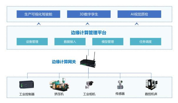
边缘计算网关对客户工厂内大量异构的现场设备(工业控制器、挤压机、工业相机等)进行联网,通过设备协议适配采集现场设备的数据。数据采集途径包括:一、与设备直接连接进行采集;二、与工业控制器连接,采集工业控制器所控制设备的数据。
