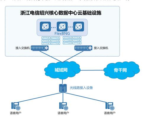
浙江电信基于城域网提供语音业务,语音用户需要经过认证并接入电信骨干网络才能实现与全国其他语音用户的互通,该业务需要通过电信设备宽带接入网关(传统上由通信设备厂商提供专用硬件设备)上线。浙江电信在绍兴城域网的云数据中心部署了公司提供的 FlexBNG 软件,构建了虚拟化的宽带接入网关,并将绍兴的语音业务通过此虚拟宽带接入网关上线,并可通过骨干网络与全国语音用户连接。
