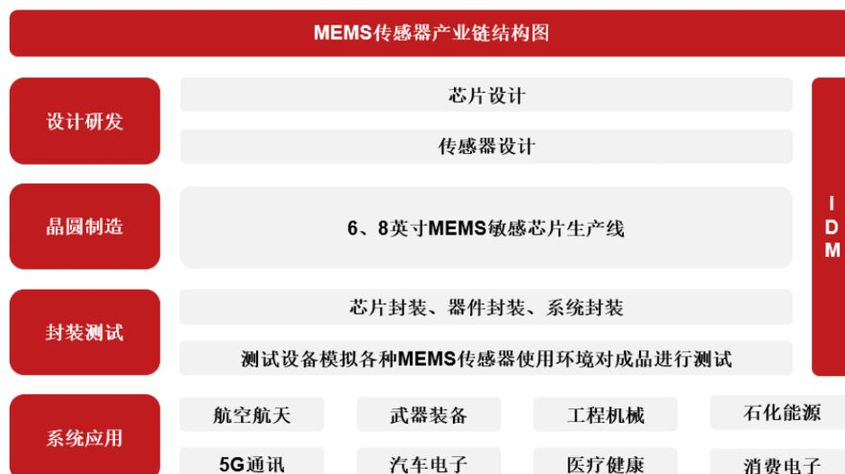
其中,设计研发包括MEMS敏感芯片设计和传感器器件设计;晶圆制造为MEMS敏感芯片的生产环节,即晶圆厂商将MEMS敏感芯片进行流片制成裸芯片;封装测试环节则包括芯片级封装(即晶圆级封装)、器件级封装和系统级封装(传感器器件应用于终端系统);系统应用为在各个特定行业领域的终端应用。
