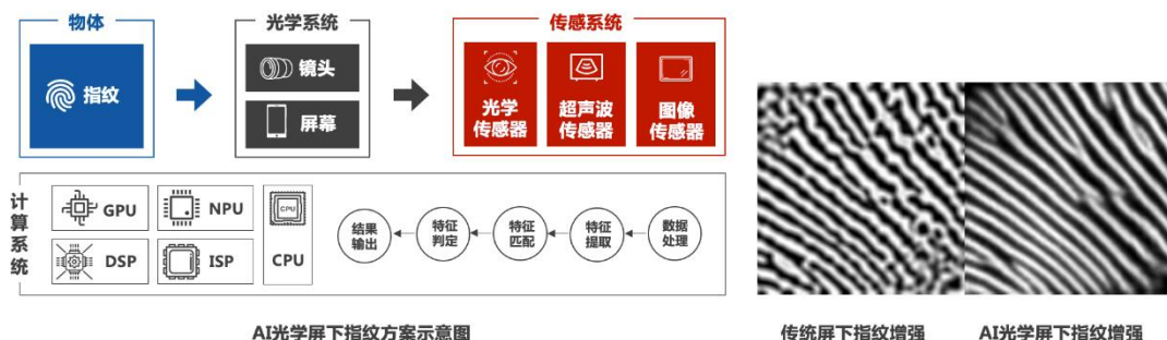
图：AI 光学屏下指纹方案示意图与公司方案效果对比图
