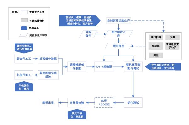
如上图所示,公司生产所用机器设备,主要在钣金件和机加件环节,以及关键部件的组装生产环节。从设备类型来看,设备价值不高;从对技术的影响程度看,设备的成新率对产品的精密度影响有限。而目前对设备参数影响较大的生产环节主要以人工为主,例如自制部件的组装生产和 X/Y/Z 轴的组装生产。上述环节使用到的测试仪、模具绕线机和频谱分析仪等设备仅为辅助设备。
