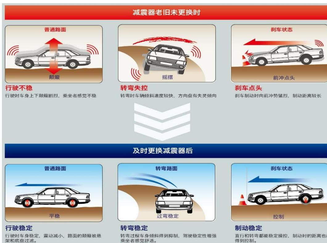
悬架系统减震器是安全件，减震器受损或性能下降将导致车辆过弯失控、刹车距离拉长等安全事件。减震器受到损坏而未及时更换，将会影响车辆的行驶稳定性、转向、轮胎与路面的接触并导致刹车性能下降，进而大幅降低驾驶的安全性。
