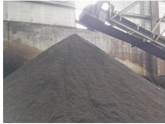
脱水干泥燃料化处理后 可直接送热电厂协同焚烧
