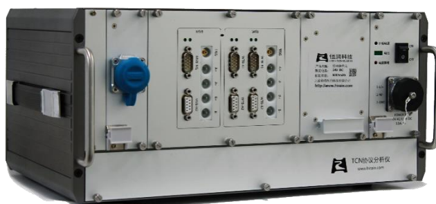
图：发行人用于列车网络检测的自研工具
