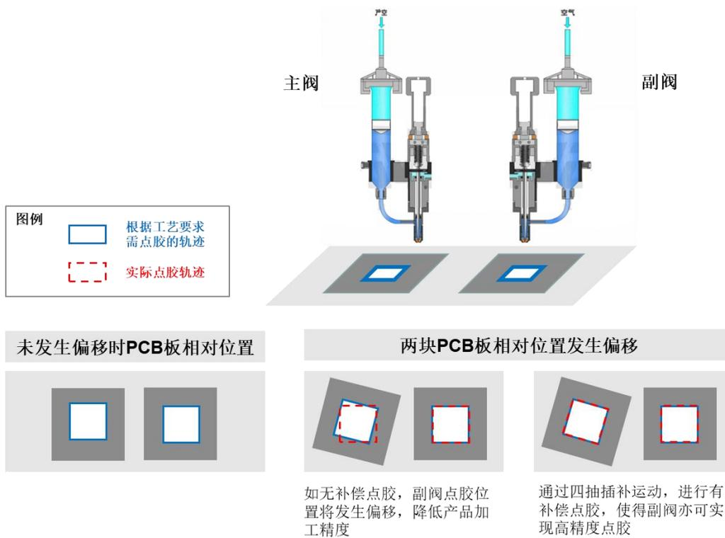
公司通过副阀插补运动结构设计和视觉定位系统，对双 PCB 板进行高精度同步点胶，实现了提升单台设备产能的同时亦能保证加工精度。主副阀的定位精度均可控制在 0.03mm 以内，双阀间距最大可达 170mm。
