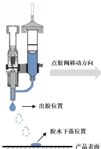
公司自主编写的运动算法技术根据运动轴在不同位置的加速度数据，结合测高系统和胶量控制系统反馈的数据，精准高效地计算胶阀应出胶位置及胶水下落位置，从而解决无停留点胶导致的胶点位置偏差问题。此外，因运动控制算法系公司自主编写，去除了冗余功能、提升了信号传递（IO）速度，进一步提升设备完成规划的点胶轨迹速度。目前，无停留点胶方式下，点胶精度最小可达 0.03mm 以内，胶阀移动速度最快可达 400mm/s，点胶效率得到极大提升，是传统非接触式点胶的 2 倍以上。
