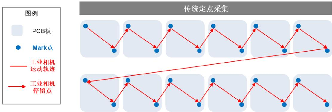
公司自主编写的运动算法软件通过精准计算触发点位，精准控制工业相机拍照位置并控制其运动轨迹，实现了工业相机在高速运动的过程中无停留采集图像，极大提升大批量视觉处理的效率。
