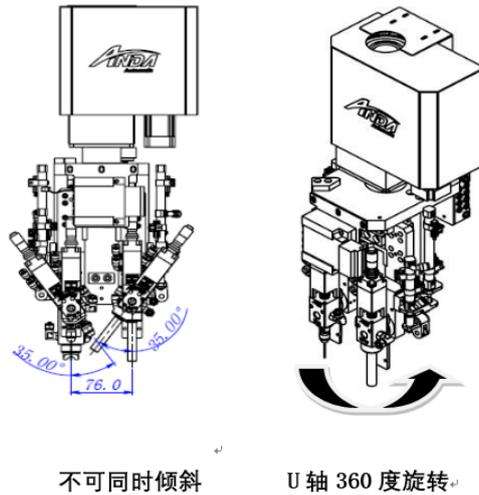
此外，公司利用视觉定位系统等运动算法技术，实现对产品的精准定位和对三阀运动轨迹的精准规划，同时基于成熟的流体控制技术对流体和压缩空气进行精准控制，从而完成三阀的各自精准喷涂，在三阀异步工作时亦能保证高精度作业。其中，点胶阀最小点胶直径 0.2mm，最高点胶距离 75mm；小雾化阀喷涂宽度可达 10mm，大雾化阀最大喷涂宽度可达 35mm。
