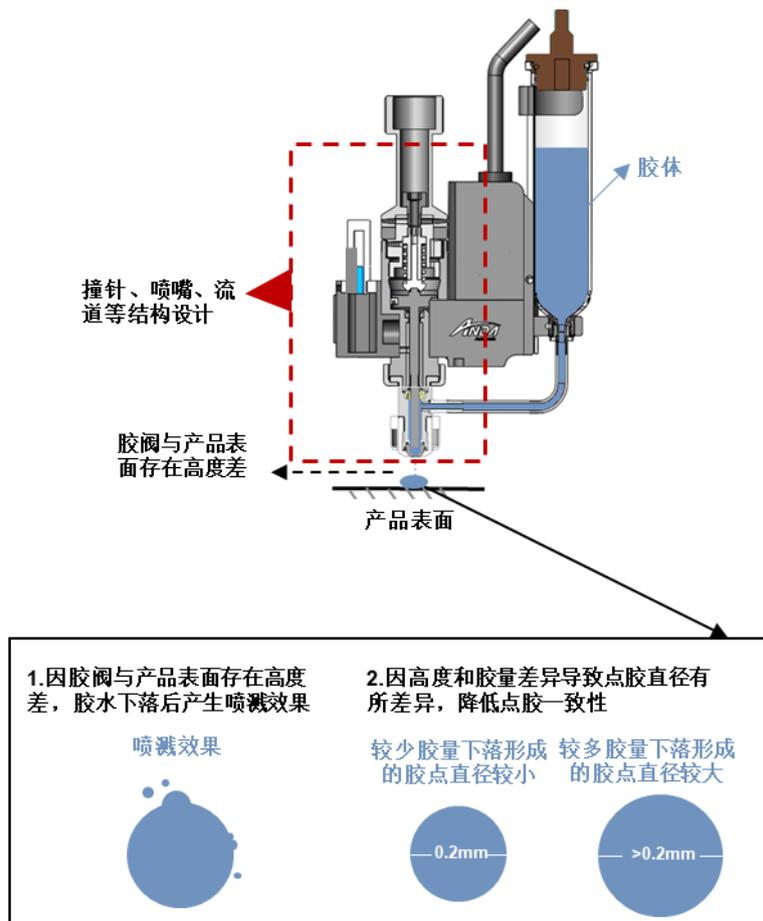
公司基于多年技术积累，通过特殊流道结构设计、高度和胶量监测系统，利用仿真模拟技术，减少了胶体下落过程中因高度差产生的释能，从而提高点胶精度、减少喷溅效果，并保证了各次点胶的胶量高度一致性。无接触式喷射点胶极大提升了单台设备产能，公司的气动喷射式点胶阀和压电喷射阀最大工作频率分别可达 200Hz 和 1000Hz，是传统接触式点胶阀工作频率的 3 倍以上。
