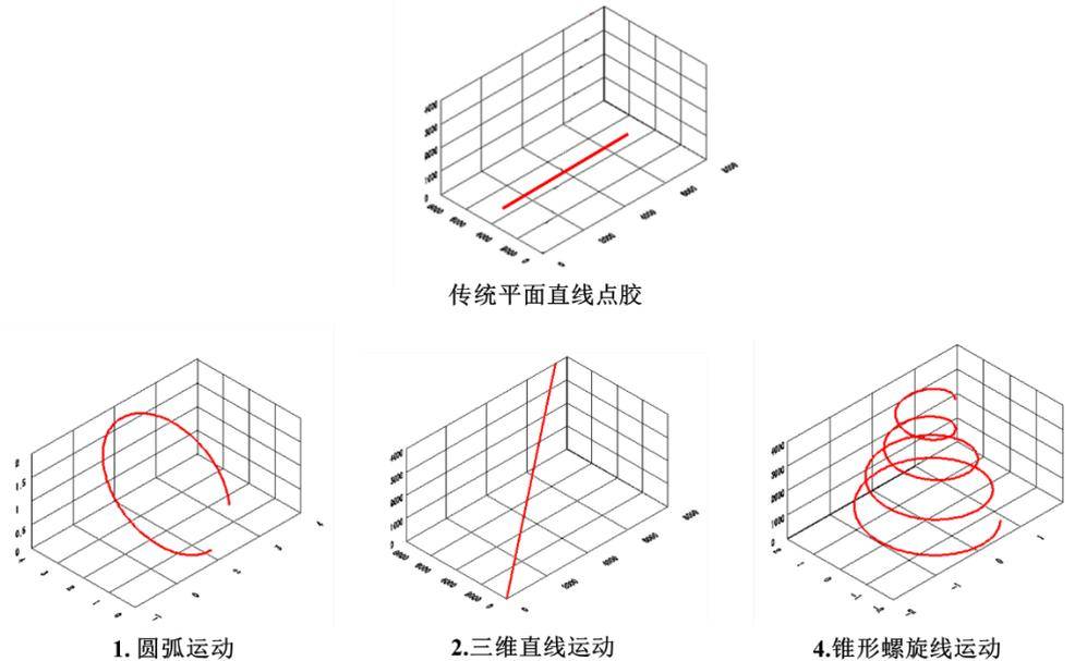
相较传统的平面直线点胶而言，多维点胶工艺在点胶过程中存在加速度、骤停的往复过程，且点胶高度因三维运动而发生不断变化，加大了对点胶阀运动轨迹和胶量精准规划的难度。公司通过 AFM 点胶软件及运动控制部件等构成的上位机，根据各点胶位置的加速度差异，精准计算出胶位置和出胶量，实现在直线、拐角与曲线等多种运动方式下的胶点位置精确规划，并保证了各胶点间距和各次点胶量的高度一致性，可将胶点间距误差控制在 0.03mm 以内。
