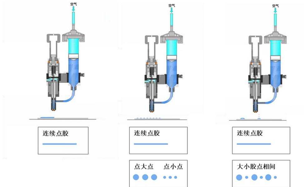
此外，公司针对喷射式点胶阀进行了消声设计，能有效降低设备运行时的噪音；自主设计的胶阀结构因接液部件易拆卸，极大提升客户进行清洗维护的便利性，缩短设备维护时间、提升单位时间产能。
