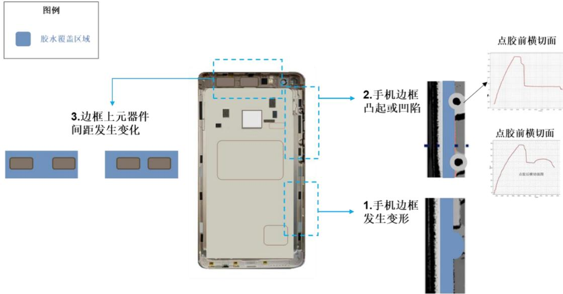
公司通过视觉模组和视觉处理技术，精准识别 PCB 板、手机边框等加工对象的异形、点胶位置缝隙等图像信息并进行数据化处理，实现对点胶阀运动轨迹的修正和胶量的实时校准，即使加工产品因前道工序环节发生异形，亦能实现较高的点胶精度和一致性。
