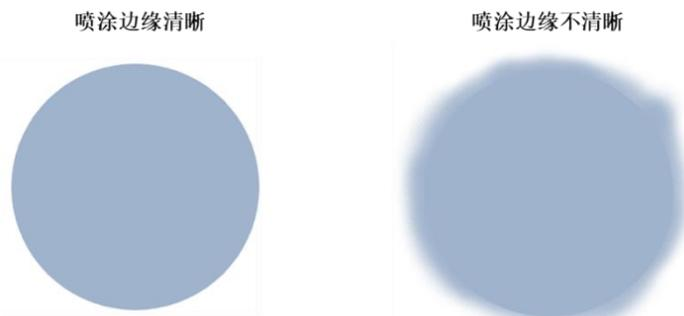
薄膜恒温恒压喷涂技术通过公司自主设计的储料罐和压力传感器、闭环加热装置，形成恒温恒压的循环供料系统，为薄膜阀提供稳定的流体与气体，保证雾化液体具有稳定特性，从而提升喷涂均匀性，解决雾化喷涂的飘洒和絮状物问题。薄膜恒温恒压喷涂技术使得公司的涂覆机在多方面具备了行业领先水平：
