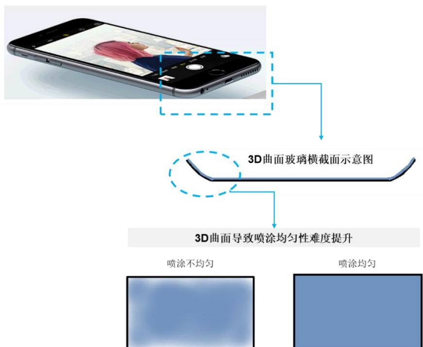
公司自主设计四方位精准倾斜机构实现了阀门的灵活旋转、无死角喷涂；基于雾化参数，快速计算出均匀喷涂产品曲面度所需的运动喷涂轨迹，以实现超薄、高一致性喷涂。公司基于 3D 曲面喷涂技术，可将产品表面不同位置的膜厚度差异控制在 10%以内，且曲面单次成膜厚度最小可达 2 $\mu\text{m}$  以内，达行业领先水平。
