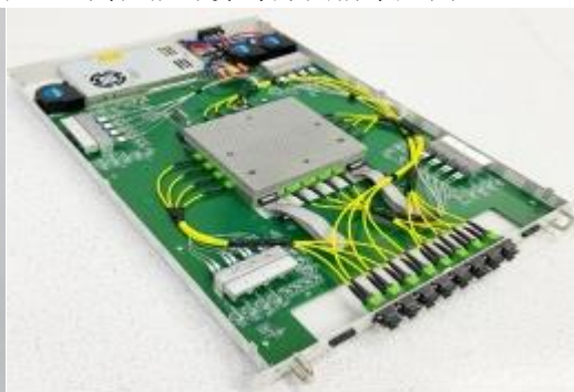
图 5. 量产版 400G QSFP-DD DR4 硅光模块
