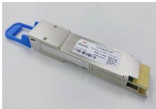
图 4.基于硅光技术的 3.2T CPO 样机
