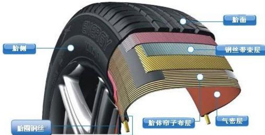
钢帘线、胎圈钢丝作为轮胎骨架材料，可以起到承受负荷和保持制品尺寸稳定的作用，很大程度上决定了轮胎制品的力学性能和使用寿命，因此在轮胎制造中作用不可或缺。但从用途来看，钢帘线和胎圈钢丝又有所差异，其中：钢帘线是子午线轮胎胎体的主要骨架材料，用于轮胎接触地面的胎面和侧面的胎壁；胎圈钢丝主要用于胎圈部分，作用是将轮胎紧密固定在轮辋上。
