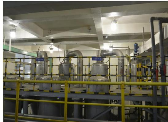
**电镀废水反渗透装置**
