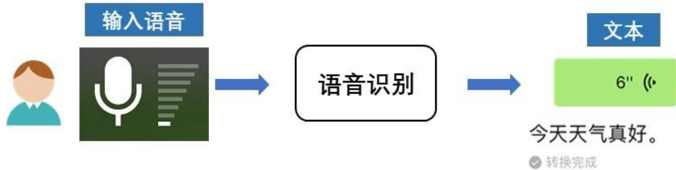
图：语音识别应用示例——即时通讯软件将发送的语音信息转换为文字
