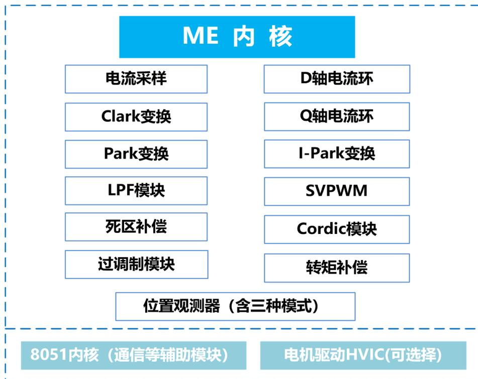
注：BLDC电机控制90%工作量由ME内核承担；8051内核仅提供辅助功能。
