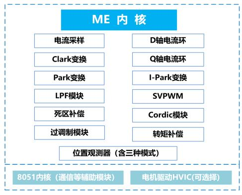
注: BLDC电机控制90%工作量由ME内核承担: 8051内核仅提供辅助功能。
