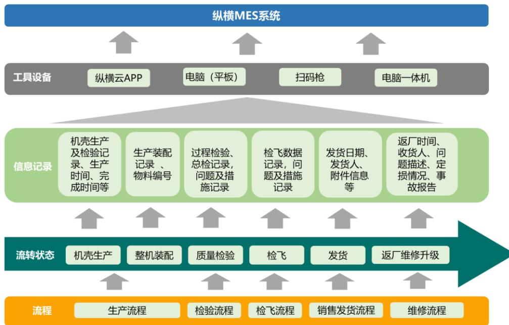
公司目前具备无人机的规模化生产能力，拥有复合材料、零部件、航电系统、整机的全自主生产能力，生产工艺成熟。公司通过引进日本马扎克车铣复合加工中心等先进的生产设备，同时结合自研非标设备、工装夹具、检验检测装置、MES 系统以及总装工艺流程优化，建立了一套以销定产、敏捷反应的无人机柔性生产制造流程，在同一生产线可以实现多品种、多批量的无人机快速生产。
