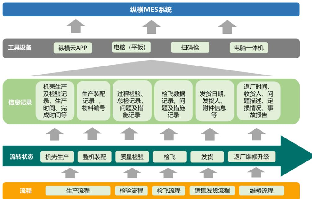
公司目前具备无人机的规模化生产能力，拥有复合材料、零部件、航电系统、整机的全自主生产能力，生产工艺成熟。公司通过引进日本马扎克车铣复合加工中心等先进的生产设备，同时结合自研非标设备、工装夹具、检验检测装置、MES 系统以及总装工艺流程优化，建立了一套以销定产、敏捷反应的无人机柔性生产制造流程，在同一生产线可以实现多品种、大批量的无人机快速生产。
