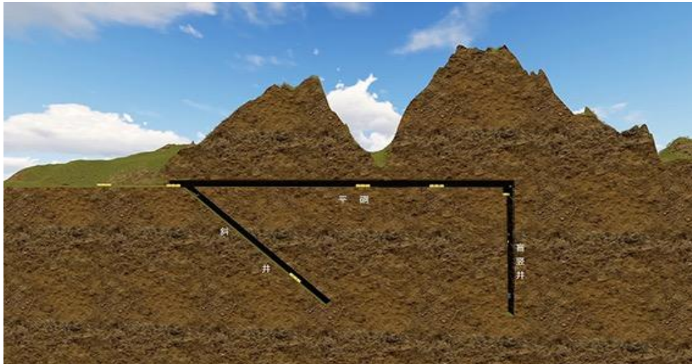
图 2：萤石采矿开拓系统示意图
