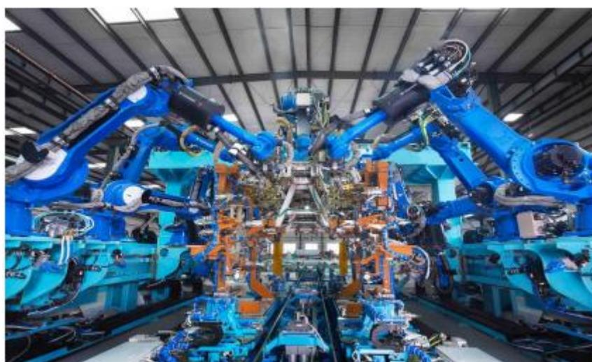
图：公司建造的总拼焊装生产线（局部）
