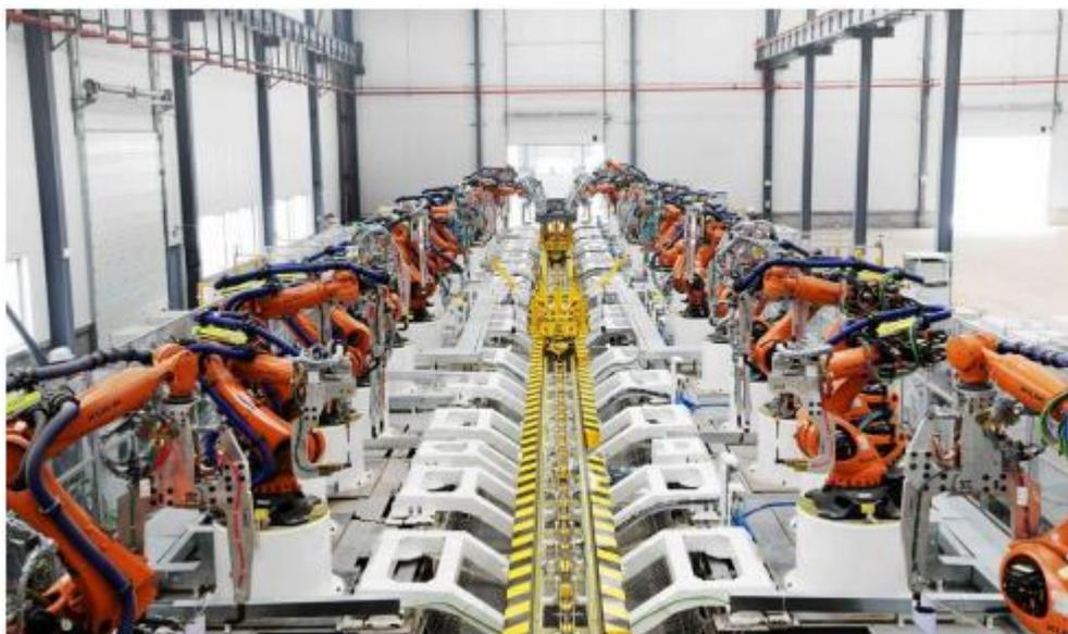
图：公司建造的地板焊装生产线
