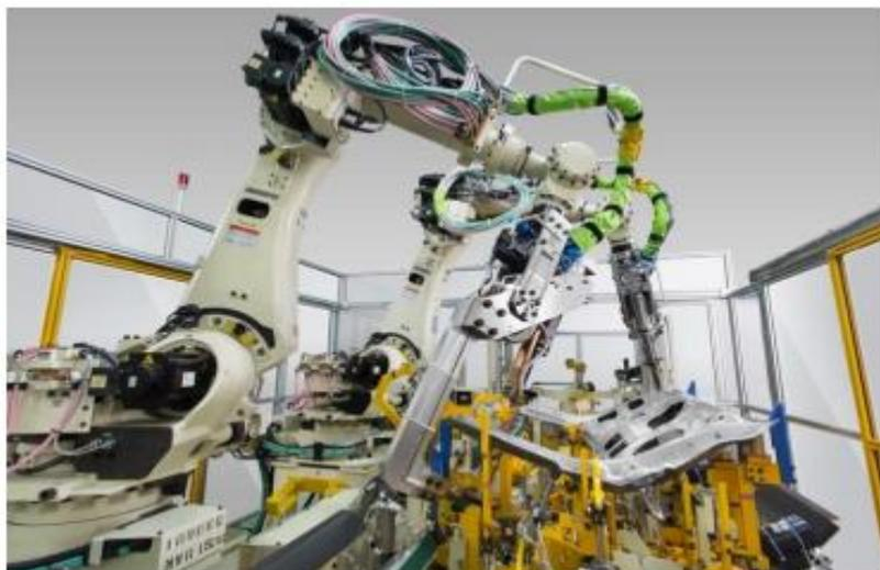
图：公司建造的门盖焊装生产线
