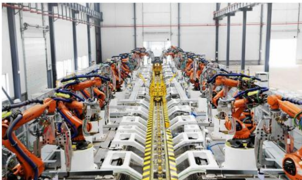
图：公司建造的地板焊装生产线
