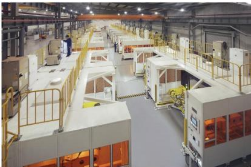
图：公司建造的摩托车焊装生产线
