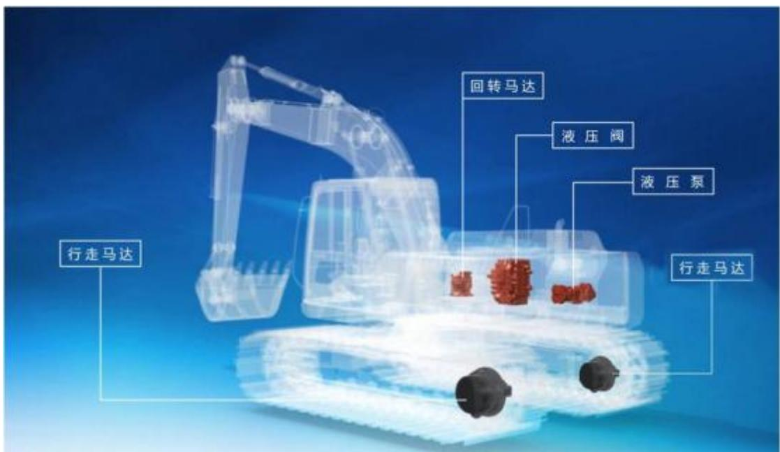
液压泵向整个液压系统提供动力；行走马达直接与液压机械的履带驱动轮或车轮相连接，驱动其直行或转向行走；回转马达一般位于液压机械的上下部件结合处，驱动上部部件旋转转向；液压阀则按操作者的指令将液压泵排出的压力油输送到各执行元件，使液压机械完成各种动作。公司目前生产的液压泵、行走马达、回转马达和多路控制阀为高压、大流量液压件产品，其技术含量高、制造工艺复杂、精密度要求严格，属于高端液压件。公司产品如下图所示：
