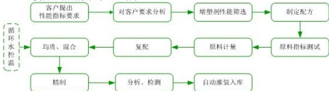
5、粉体（液体）稳定剂的生产工艺流程
