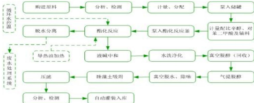
4、复合型增塑剂的生产工艺流程
