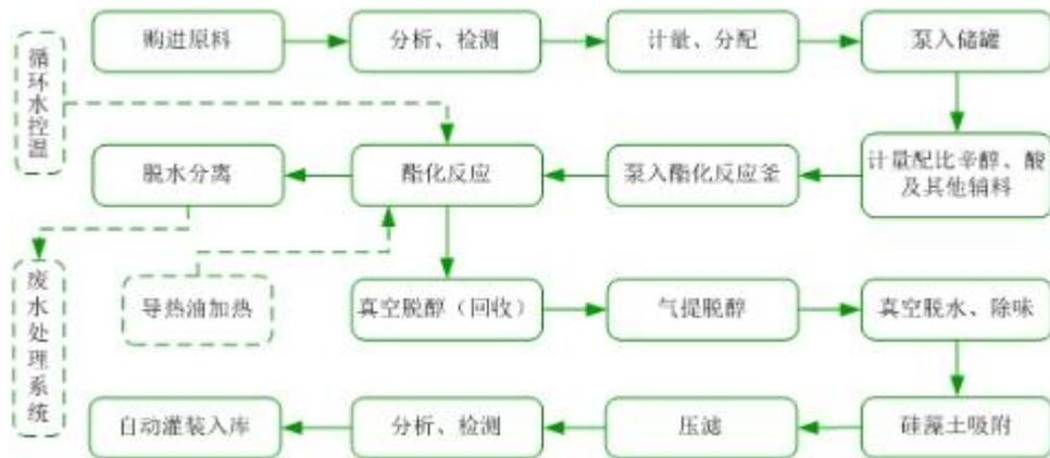
3、DOTP 的生产工艺流程
