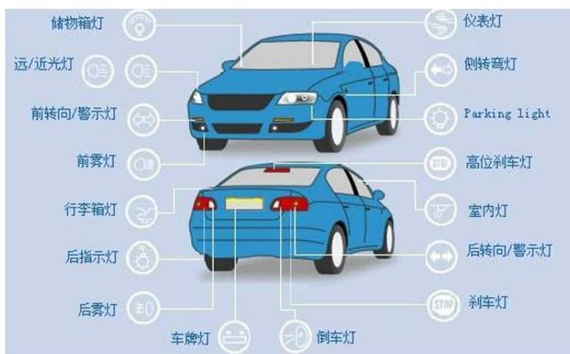
公司汽车照明控制系统产品主要包括主光源控制器、辅助光源控制器和氛围灯控制器，其中主光源控制器为汽车前大灯控制器，根据灯源的不同可进一步分为应用于氙气高压放电灯（HID）的 HID 主光源控制器以及应用于 LED 灯的 LED 主光源控制器。此外，公司还正在着手研发 LED 汽车尾灯控制器。公司生产的汽车照明电子控制器可根据各类传感器传输的信号，通过复杂的控制逻辑和算法，实现远光灯、近光灯、日间行车灯、转向灯等车身灯具的自动启动和正常运行，并可在弯道、上下坡、转弯、雨雾天、会车等不同的行车环境和路况条件下计算出最优的照明亮度和角度，主动为驾驶员提供最佳照明，保障驾驶员的行车安全。
