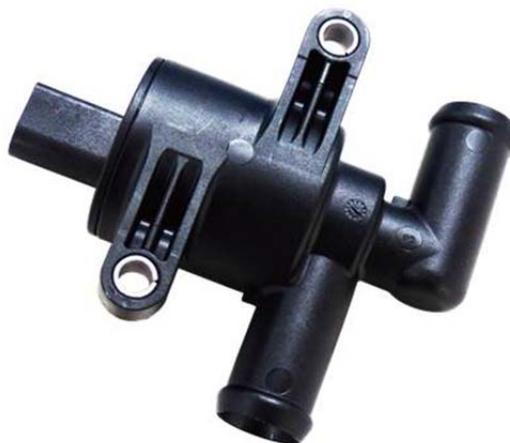
电磁阀执行器负责关闭或开启自动变速器（ATF）油冷器的冷却液循环系统。汽车刚刚启动时，电磁阀执行器关闭 ATF 油冷器的冷却液循环系统，促使 ATF 快速升温。当 ATF 达到理想工作温度后，电磁阀执行器打开 ATF 油冷器的冷却液循环系统，以达到最大冷却效果。
