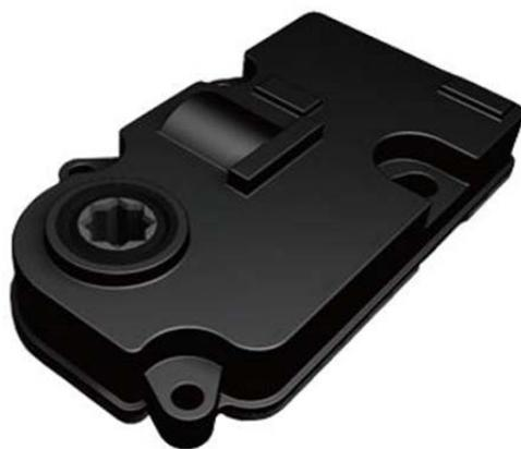
主动进气格栅系统可以根据车速、机舱温度等参数改变进气格栅的开闭角度，控制发动机舱的进气量以及整车风阻。低温时采用 AGS 可以减少暖机时间达到降低油耗的目的；高速时采用 AGS 可以减少整车风阻，提高动力性；甚至在空调处于冷却功能时，依然可以控制 AGS 处于适当的开度以减少风阻。通过优化 AGS 控制器的控制策略，AGS 可以显著提升汽车的节能性和动力性。
