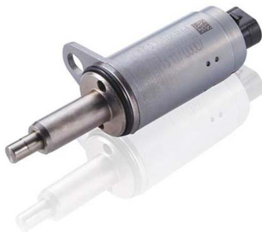
电磁阀的作用就是通过调节发动机可变气门，从而改变进气门的进气流量和进气流速，使燃料充分燃烧，实现节能减排。
