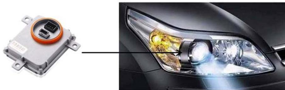
氙气灯即高强度气体放电灯（High Intensity Discharge Lamp，简称 HID）。与常规卤素灯相比，HID 灯亮度提升约 300%，耗电节省约 40%，色温接近日光，使用寿命提高近 10 倍。氙气灯必须依靠 HID 主光源控制器（即汽车电子镇流器）才能正常工作，HID 主光源控制器控制系统启动、运行及结束的整个过程，决定着 HID 灯的工作特性和寿命。目前，氙气大灯以其较优越的照明性能和较高的性价比，成为大部分车型的主流配置。
