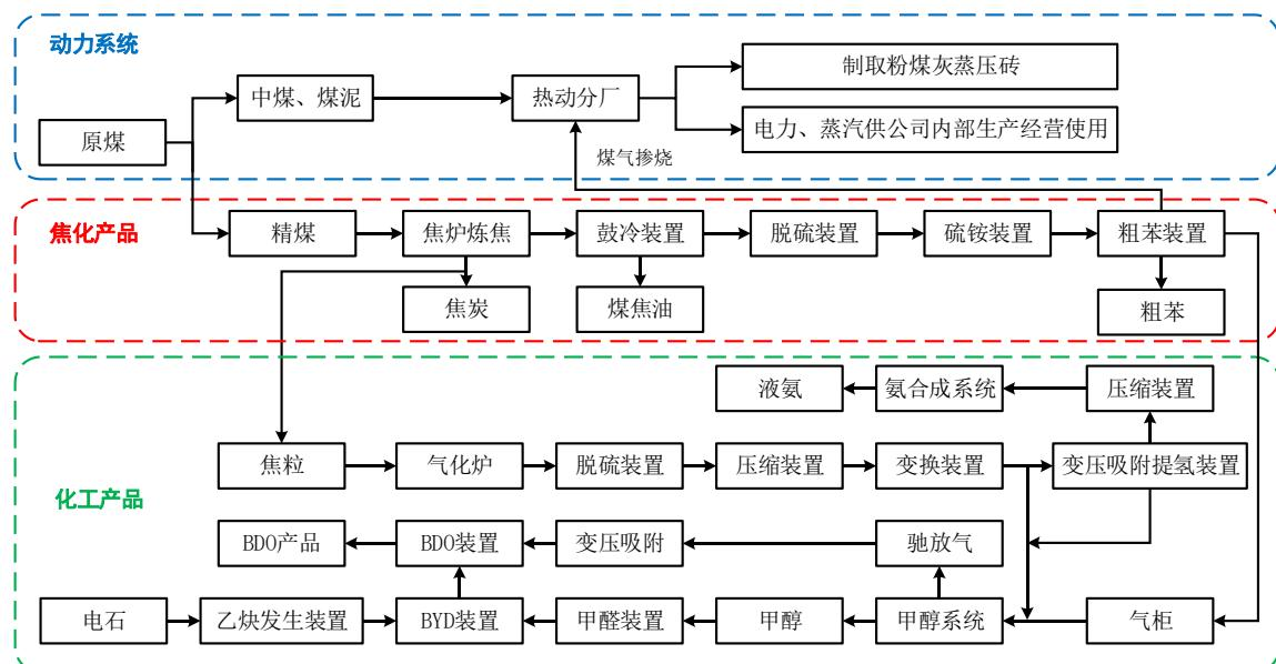
另一部分为龙门煤化生产线，位于龙门镇龙门工业园区，以“400 万吨/年焦化技改项目”、“合成氨/尿素项目”为主体，利用焦炉煤气和焦粒气化制 LNG 联产甲醇，以及利用 LNG 联产甲醇剩余氢气和分离出的氮气、二氧化碳制合成氨联产尿素。
