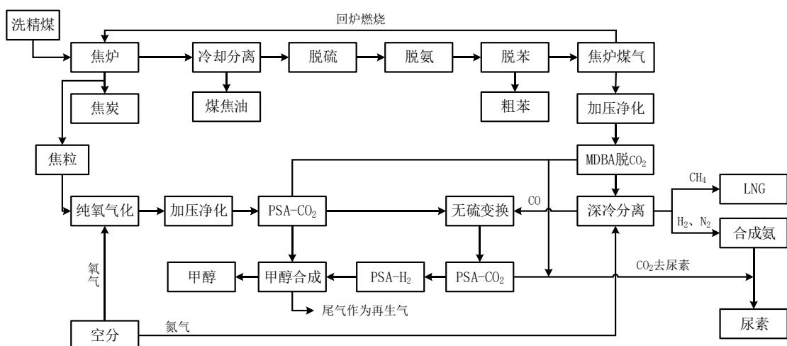
公司整个循环经济产业链的生产过程中主要是原材料精煤的一次性投入，将上游产品的副产品或废气作为下游产品的原料，充分综合利用煤、水等各项资源，降低产品成本，提升产品竞争力。同时通过综合利用焦炉煤气、粉煤灰制砖、循环利用处理后的工业污水，实现废水、废渣零排放，废气达标排放，使公司的经济增长方式一改传统的“资源→产品→废弃物”的单向直线过程，实现“资源→产品→废弃物→再生资源”的循环过程。不但做到了变废为宝、节能减排，而且提高了企业的经济效益，实现了经济发展与环境保护的双赢。
