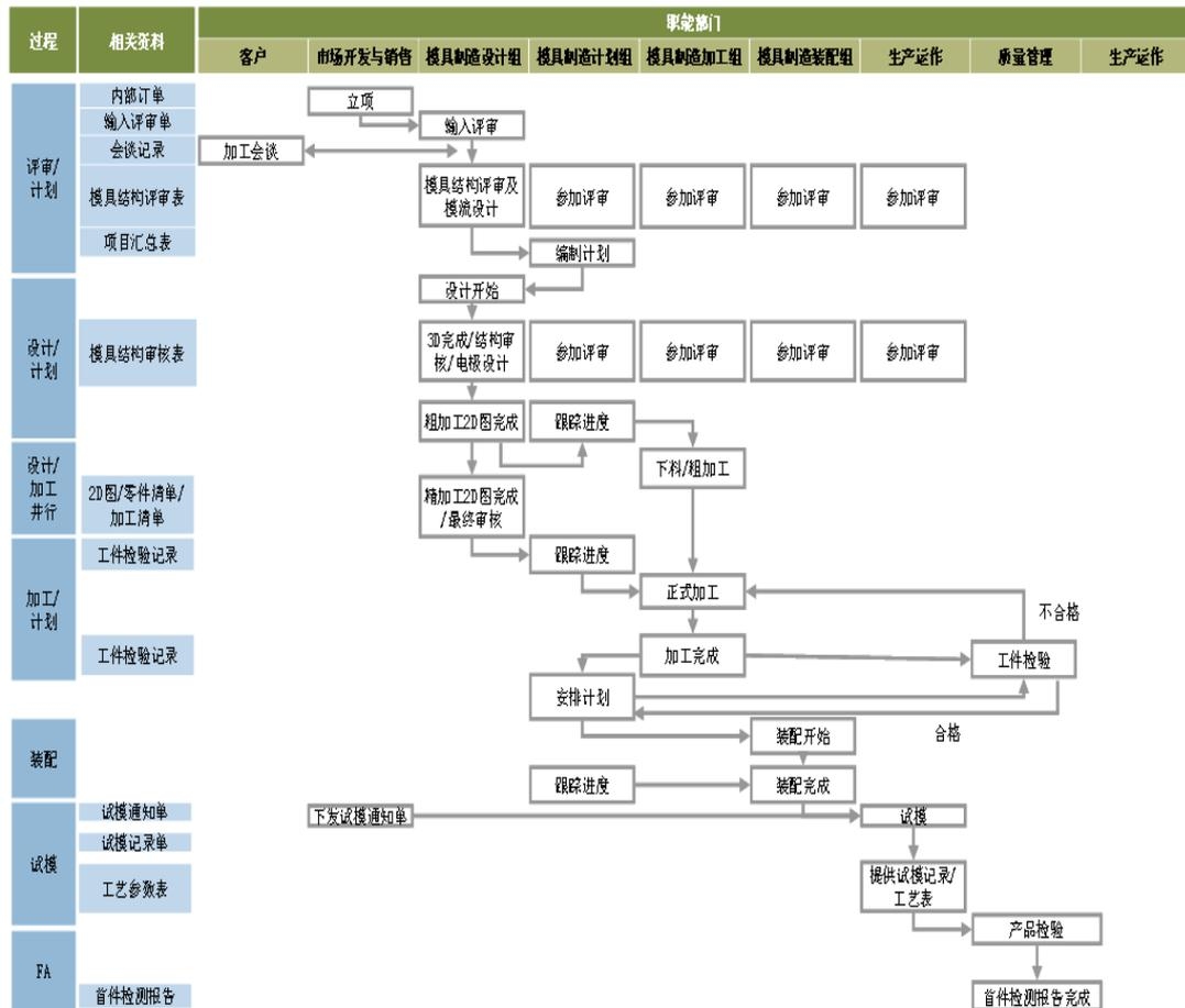
2. 精密注塑件生产工艺流程
