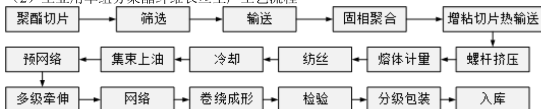
(2) 工业用单组分聚酯纤维长丝生产工艺流程
