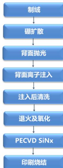
基于钝化接触的 TOPCon 电池，离子注入主要用于多晶硅的高剂量掺杂和绕镀多晶硅的选择性刻蚀。和 N-PERT 电池一样，用扩散对背面多晶硅进行掺杂时需要在电池正面制作掩模保护层，使得电池制造工艺变得复杂。采用离子注入不仅可以对多晶硅进行精确可控的掺杂，并且注入后形成的非晶硅层可以作为碱刻蚀的阻挡层，通过简单的碱刻蚀步骤即可去除绕镀到正面的多晶硅，工艺步骤对比扩散更简单。TOPCon 电池离子注入工艺路线如下：
