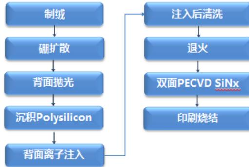
于钝化接触的 TOPCon IBC 电池，离子注入主要用于 TOPCon IBC 电池背面 P 型多晶硅的硼掺杂和 N 型多晶硅的磷掺杂，以及电池正面的前表面场的掺杂。由于 IBC 电池的背面同时具有 P 型区域和 N 型区域，为了避免电池漏电，P 型区域和 N 区域之间的隔离是必须的。实验室研发采用了复杂的掩模刻蚀工艺来实现 P 型和 N 区域的隔离，工艺复杂。利用离子注入后形成的非晶硅层可以作为碱刻蚀的阻挡层的特性，用离子注入技术可以非常简单的实现 P 型和 N 型区域的隔离，离子注入对比热扩散有无法比拟的优势。利用离子注入技术实现 TOPCon IBC 电池背面 P-N 区域隔离情况如下：
