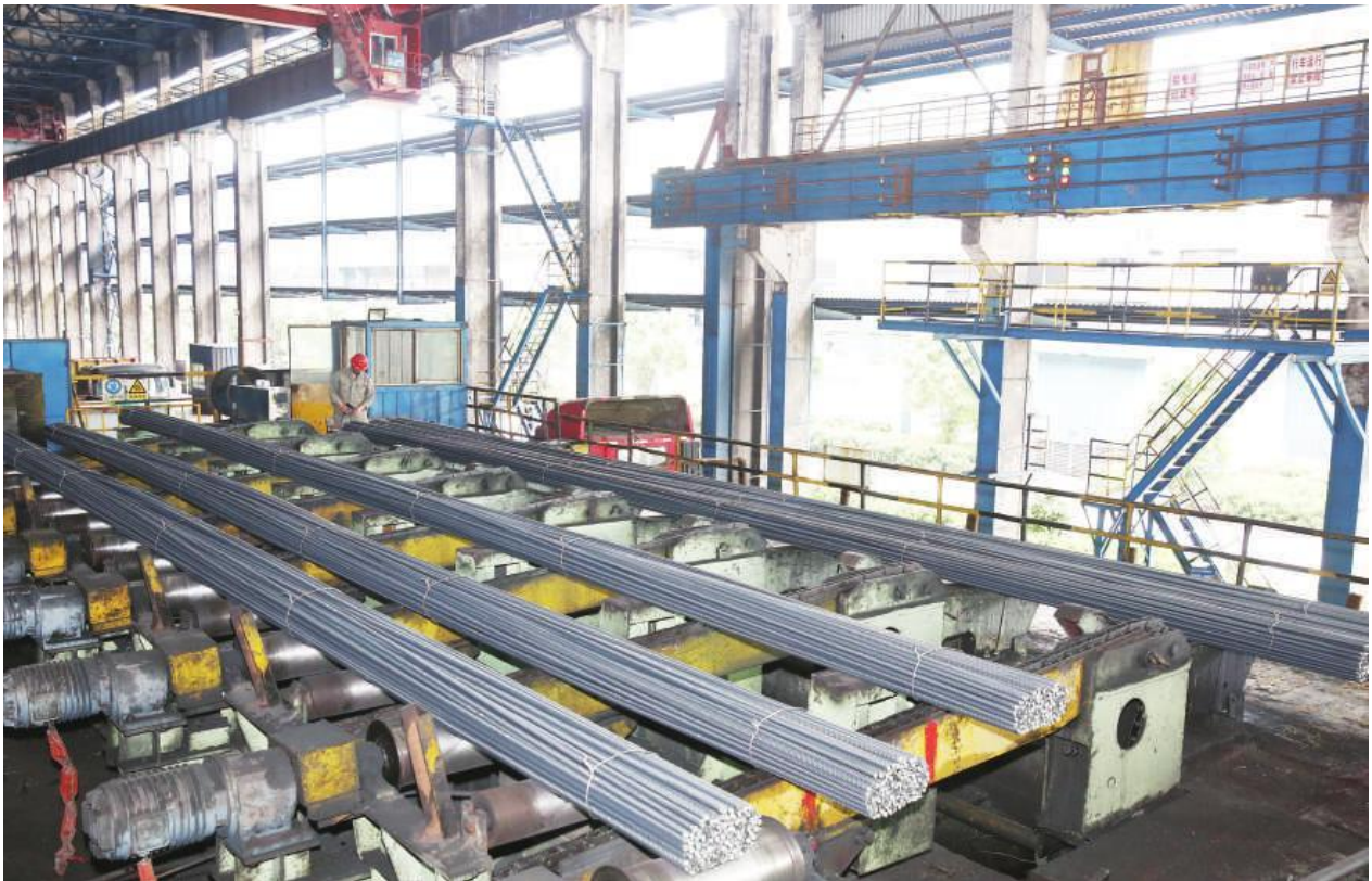
图为质检员检查螺纹钢尺寸和表面质量。
