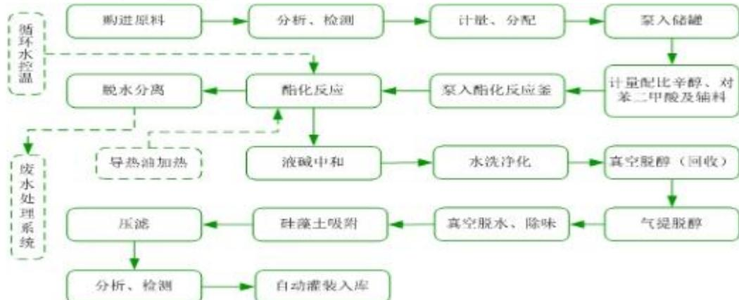
4、复合型增塑剂的生产工艺流程
