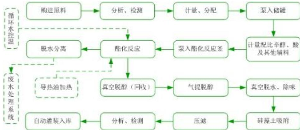
3、DOTP 的生产工艺流程
