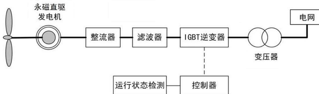
目前风力发电主要有双馈异步和永磁直驱两大类发电机组类型，双馈异步型发电机采取在叶轮和电机间设置增速齿轮箱的方式提升转速以匹配发电机，而永磁直驱型发电机则是采取增加磁极对数的方式，使得发电机的额定转速下降，从而省去了增速齿轮箱等易损部件。
